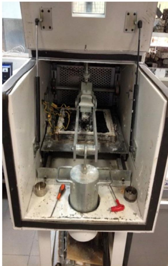
Laje e equipamento do ensaio WTT
